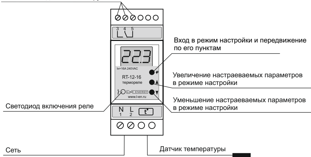
Рис 1. Устройство прибора
