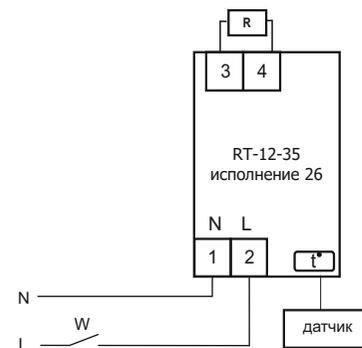
Рис 2. Схема подключения при нагрузке до 5,0кВт
