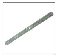
Трубка ротаметрическая - это одна из основных частей ротаметра. Ротаметрические трубки обычно изготавливаются из стекла, на котором наносится шкала, внутри которой перемещается поплавок во время работы.
