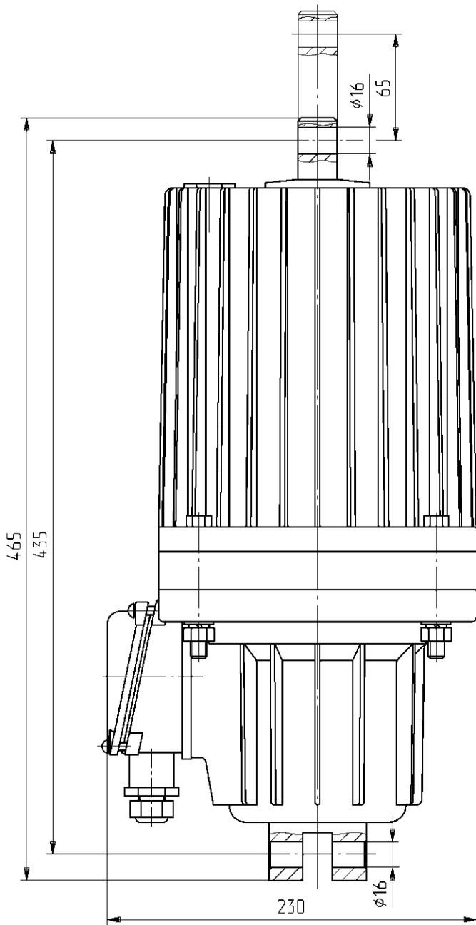
Рис. 1. Габаритные и присоединительные размеры ТЭ-50
