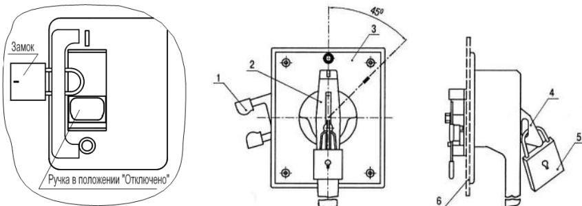
**Рисунок 3 – Запирающее устройство в положении «Отключено»:**
