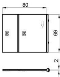
**Рисунок Б.4 – Габаритные размеры межполюсных перегородок**
