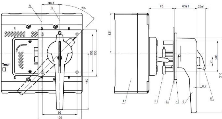
**Рисунок Б.3 – – Выключатель с ручным дистанционным приводом для оперирования через дверь распределительного устройства:** А – вертикальная ось выключателя; В – вертикальная ось ручного дистанционного привода. 1 – выключатель; 2 – поводок привода; 3 – дверь распределительного устройства; 4 – основание привода; 5 – рукоятка привода; 6 – запирающее устройство.
