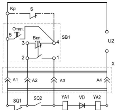
**Рисунок В.6** – Электрическая принципиальная схема привода электромагнитного
